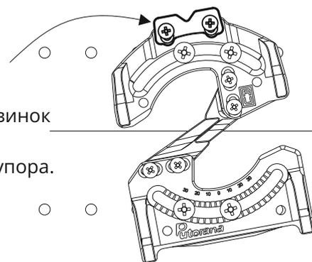
Рекомендуется при установке и настройке креплений использовать синий фиксатор резьбы.
